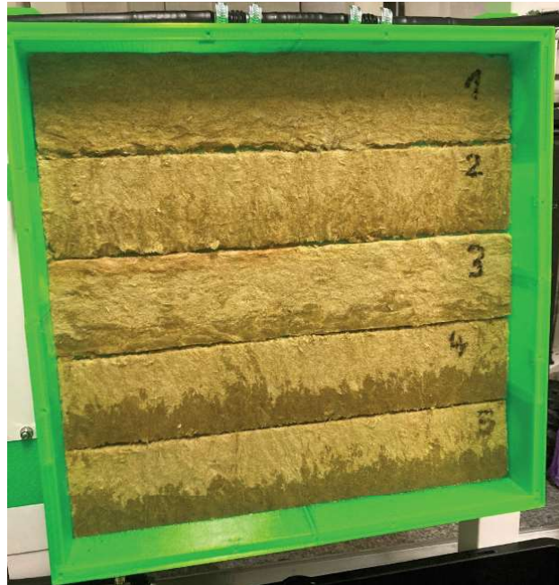
Obr.: Foto testování různých směrů vláken ve vatě Isover intense, která se ukázala jako nejpoužitelnější.
