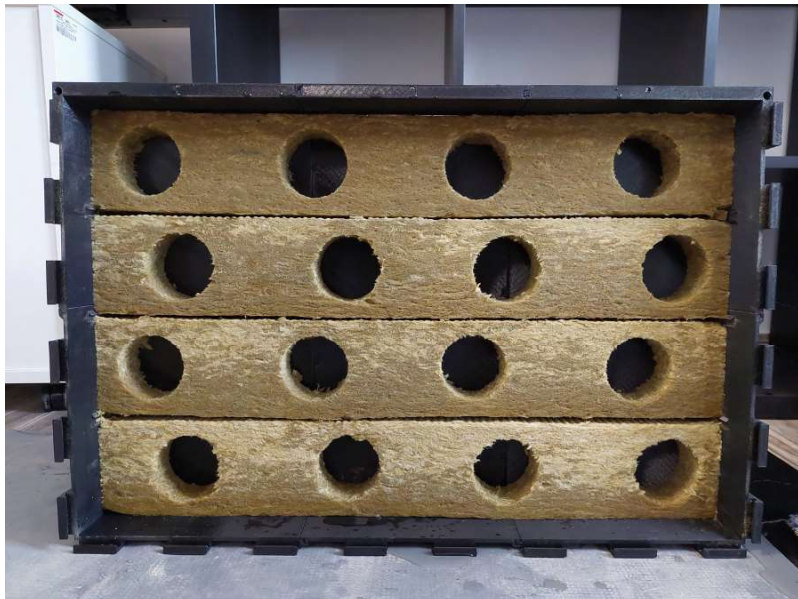
Obr.: Testování distribuce vody v modulu v průběhu času.
