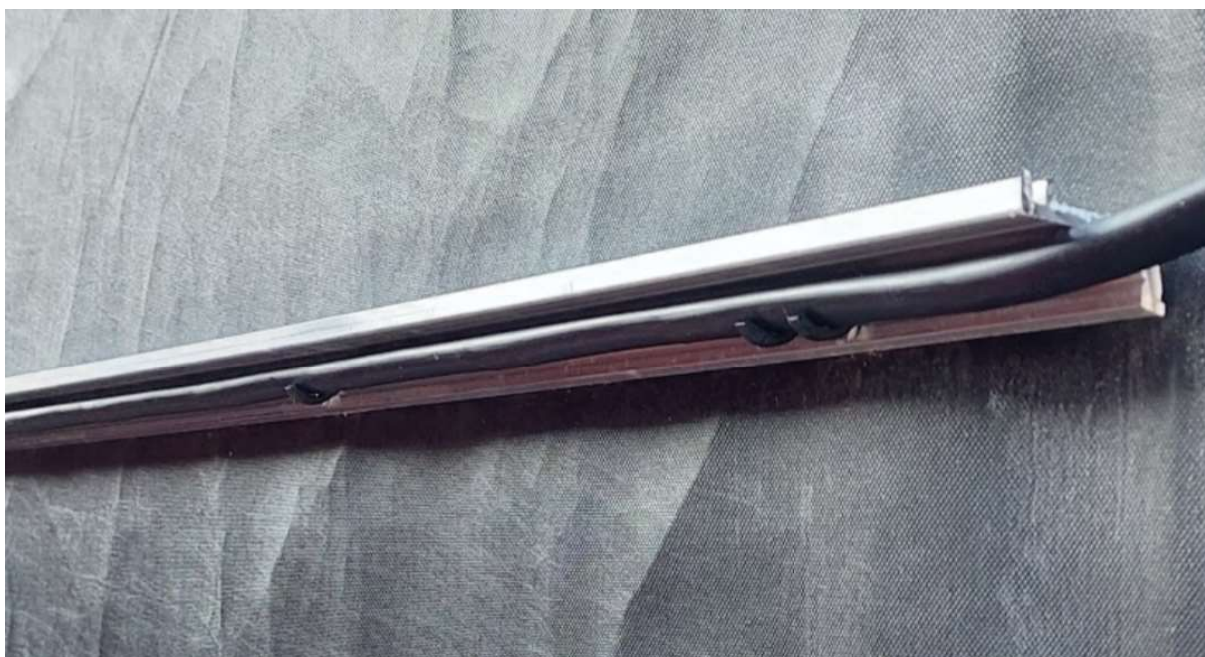
Obrázek 3: schéma vložení háčku do nosné lišty
